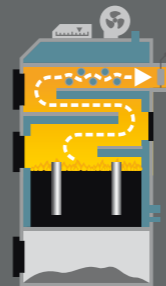
Структурная схема котла KSX (кроме котла KSX 13)
